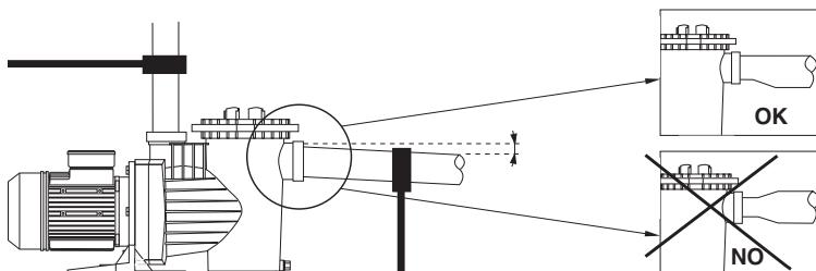
Emiş ve basma hatlarının pompa bağlantısının dışında desteklenmesi çok önemlidir. Tesisatin su akışından kaynaklanan titreşimlerin pompa bağlantısı ile desteklenmesi mümkün değildir. Uzun mesafeli basma hatlarında pompanın ani durdurulmasından kaynaklanan su çekicini önlemek için basma hattına çekvalf bağlanması önerilir.
