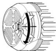
Verifique se o sentido de rotação do motor coincide com o indicado na placa de características (a ventoinha deve rodar, olhando pela parte traseira do motor, no SENTIDO DIRECTO). Se a bomba for trifásica e observarmos que o sentido de rotação é incorrecto, devem-se inverter duas fases de alimentação do quadro de protecção.
