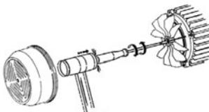
Verificare che il senso di rotazione del motore coincida con quello indicato sulla targhetta delle specifiche tecniche (il ventilatore deve ruotare, guardando dalla parte posteriore del motore, in SENSO ORARIO). Se la pompa è trifase e si osserva che il senso di rotazione è errato, si dovranno invertire due fasi di alimentazione del quadro di protezione.
