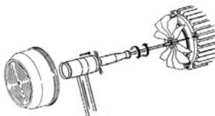
Motor şaftının (arkadan bakılarak) pompa üzerinde belirtilen yönde (SAAT YÖNÜNDE) döndüğünden emin olunuz. Eğer üç fazlı motorlarda şaftın ters yönde döndüğü tespit edilirse, güç sağlayan iki faz kontrol panosundan ters değiştirilmelidir.
