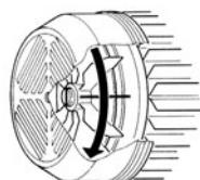
Compruebe que el sentido de giro del motor coincida con el indicado en la placa de características (el ventilador debe girar, mirando por la parte trasera del motor, en SENTIDO HORARIO). Si la bomba es trifásica y observamos que el sentido de giro es incorrecto se deben invertir dos fases de alimentación del cuadro de protección.
