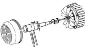
Zkontrolujte, zda směr otáčení motoru souhlasí s údajem uvedeným na výkonovém štítku (vrtulka ventilátoru se musí při pohledu ze zadu točit VE SMĚRU HODINOVÝCH RUČIČEK). Jestliže se jedná o třífázový motor a zjistíme, že se točí opačným směrem, je nutno mezi sebou vyměnit na jističi dva fázové přívodní vodiče.
