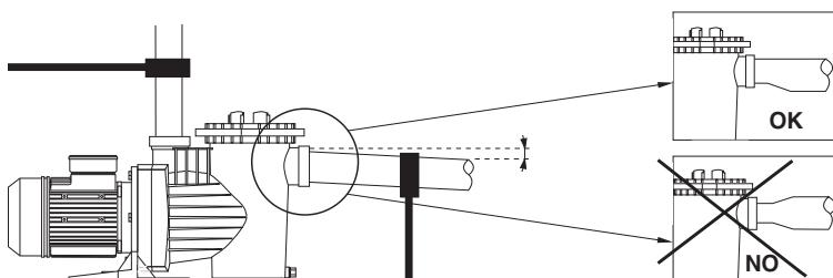
Je velmi důležité, aby sací i výtlacné potrubí byla nezávisle podepřena a správně upevněna tak, aby čerpadlo nemuselo nést jejich váhu a netrpělo vibracemi vznikajícími při proudu vody v těchto potrubích. Pokud se použije dlouhé výtlacné potrubí, doporučujeme nainstalovat zpětný ventil, aby se předešlo rázu vody při jejím zpětném proudu po zastavení čerpadla, což by mohlo zařízení poškodit.
