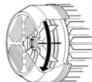
Vérifier que le sens du mouvement tournant du moteur coïncide avec celui qui est indiqué sur la plaque des caractéristiques (le ventilateur doit tourner, en regardant par le côté arrière du moteur, dans LE SENS DES AIGUILLES D'UNE MONTRE). Si la pompe est triphasique et que nous observons que le sens du mouvement est incorrect, il faudra inverser deux phases d'alimentation du tableau de protection.
